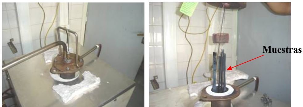
Figura 2. Horno montado para la realización de simulaciones de diferentes ciclos.
