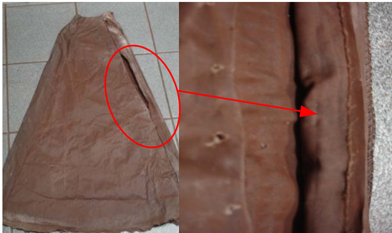
Figura 1 – Tecido de poliéster com rasgo na lateral, ampliação do rasgo do tecido.
