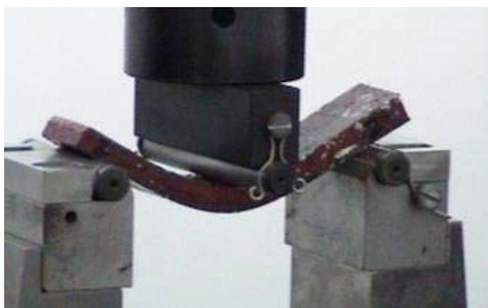
**Figura 1.** Exemplo de corpo de prova retirado de um painel compósito de resíduo polimérico sendo ensaiado em flexão.
