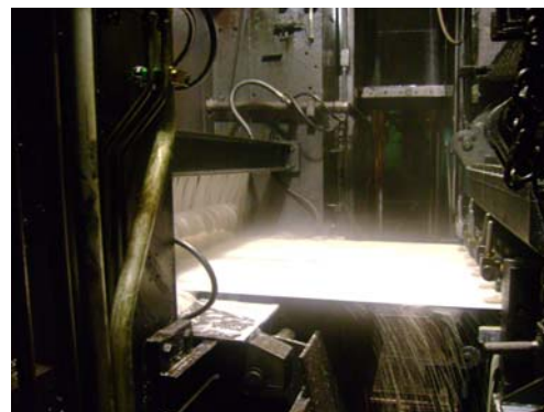
Figura 7b – Coletor de refrigeração do vão 2/3
