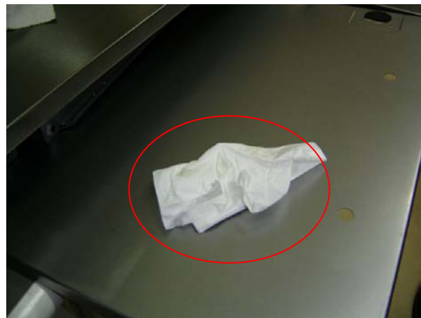
Figura 9b – Material apresentando limpeza superficial adequada após teste de limpeza com papel
