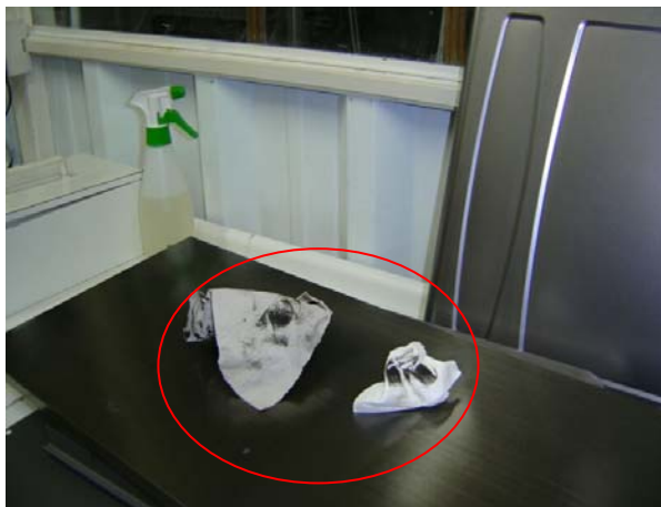
Figura 9a – Material apresentando resíduo excessivo após teste de limpeza com papel
