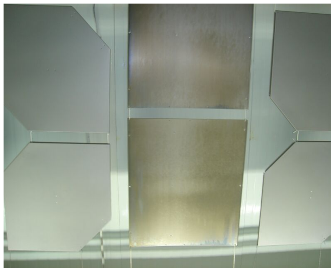
Figura 1 – Material durante a aplicação apresentando manchas escuras (em destaque).
