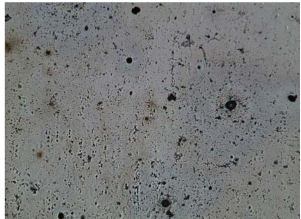
**Figura 1d)** Micrografia da liga 1050 após imersão em NaBr 0,0043 M.
