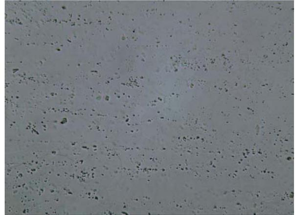
**Figura 1c).** Micrografia da liga 1050 após eletropolimento.
