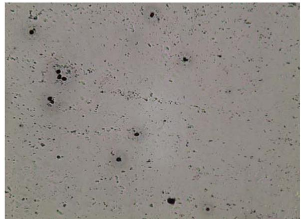
**Figura 1e)** Micrografia da liga 1050 após 24 h de imersão em NaBr 0,0043 M.
