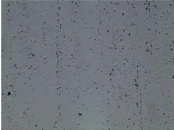
**Figura 1a).** Micrografia da liga 1050 após eletropolimento
