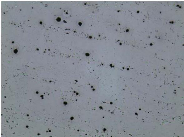
**Figura 1b)** Micrografia da liga 1050 após 24 h de imersão em NaCl 0,0043 M.
