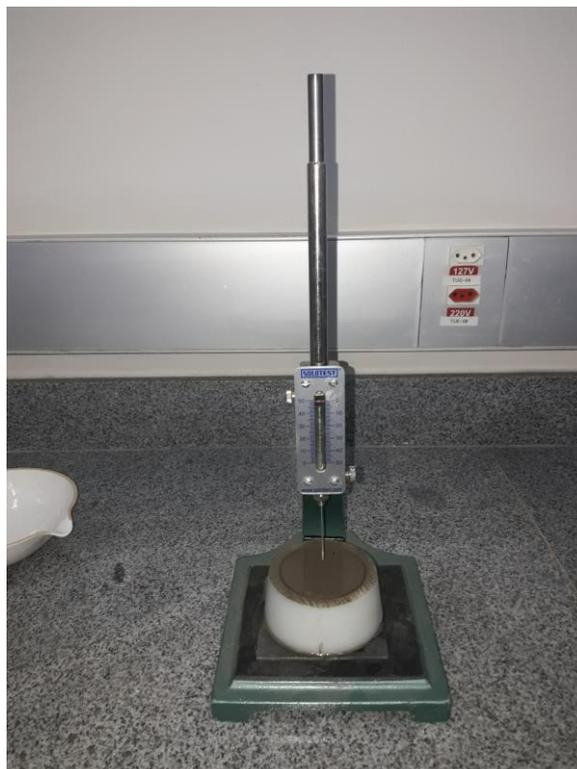
**Figura 3.** Determinação do início de pega da pasta de cimento, utilizando agulha de Vicat.
