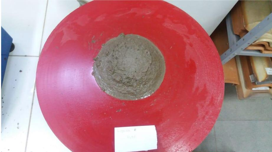
**Figura 1.** Determinação do diâmetro da argamassa sobre o tampo da mesa de queda.
