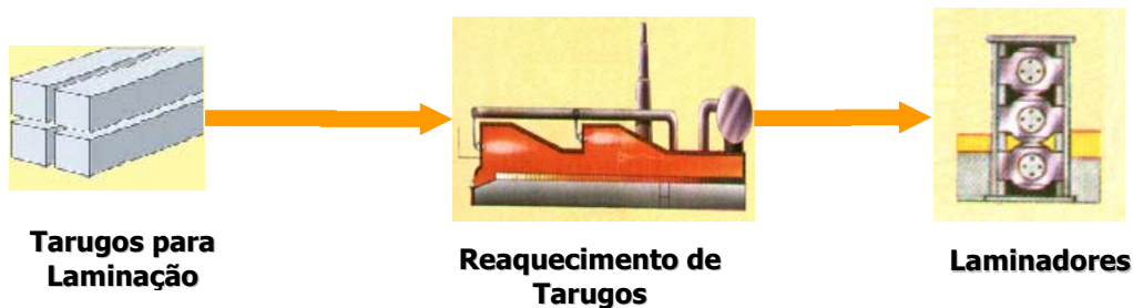
Figura 3. Fluxograma de laminação de tarugos.
