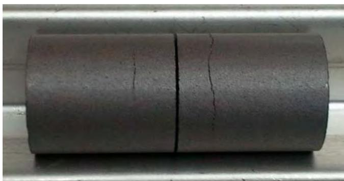
Figura 2: Pastilhas tipo padrão apresentando trinca transversal na área de superfície de sua circunferência.
