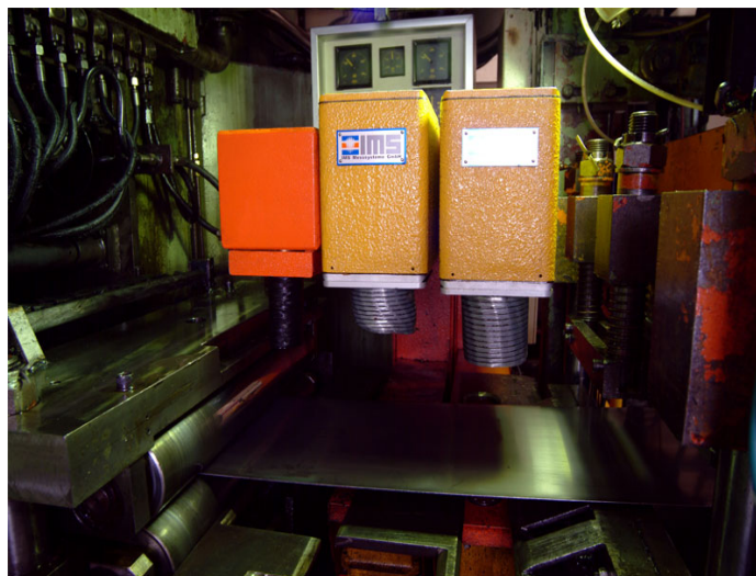
Figura 2. Equipamento de medição por meio de raios-X utilizado para controle da redução.
