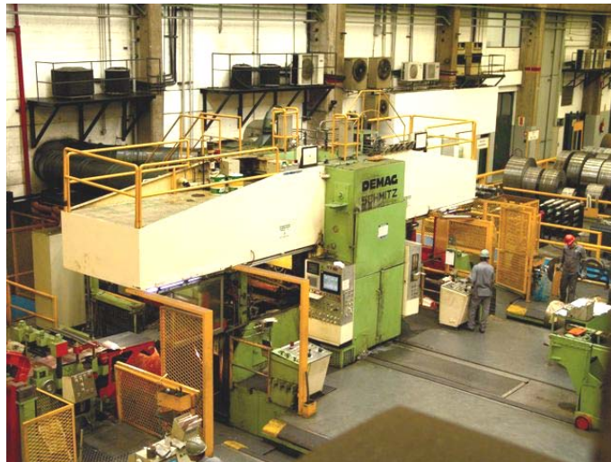
Figura 1. laminador utilizado para produção das amostras
