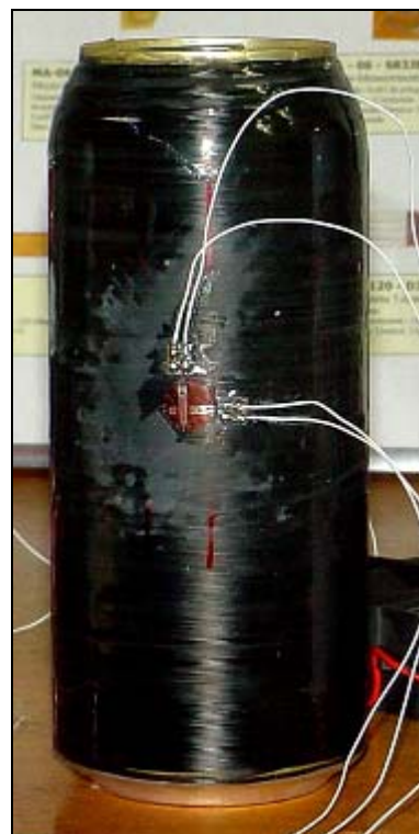
Figura 6. Diagrama pressão hidrostática versus deformação com os dados extrapolados até a ruptura do vaso. Fotografia do vaso de pressão bobinado e instrumentado para o ensaio hidrostático.
