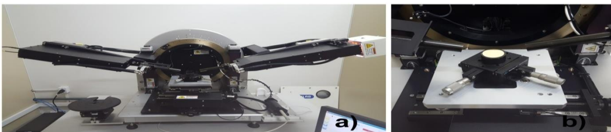
Figura 3. Elipsometria Espectroscópica. a) Panorama do equipamento. b) Visão da amostra.
