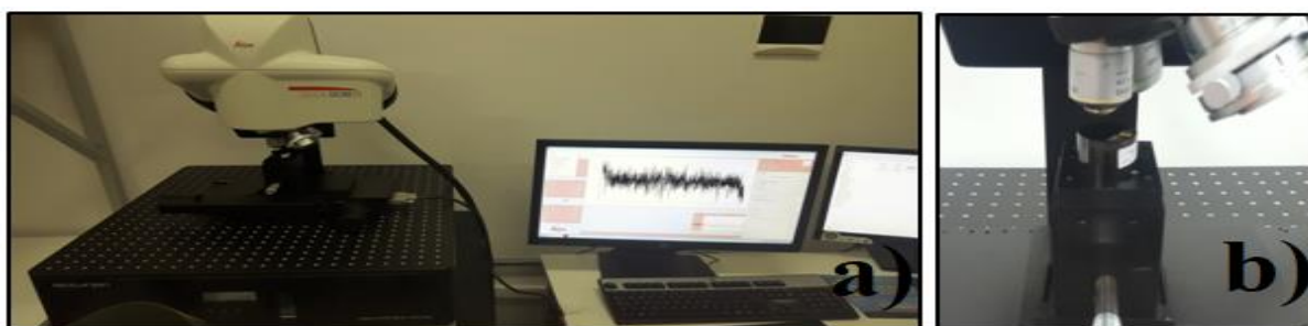
Figura 2. Microscopia Confocal. a) Panorama do equipamento. b) Visão da amostra.
