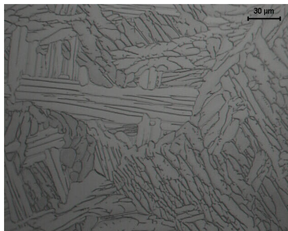
Figura 2. Micrografia da liga Ti-6Al-4V com estrutura de Widmanstätten.
