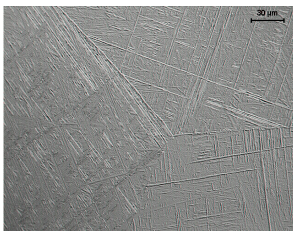
Figura 4. Micrografia da liga Ti-6Al-4V com estrutura Martensita.
