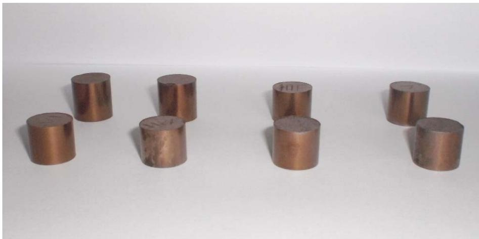
**Figura 9.** Amostras de aço 1045 sinterizado.
