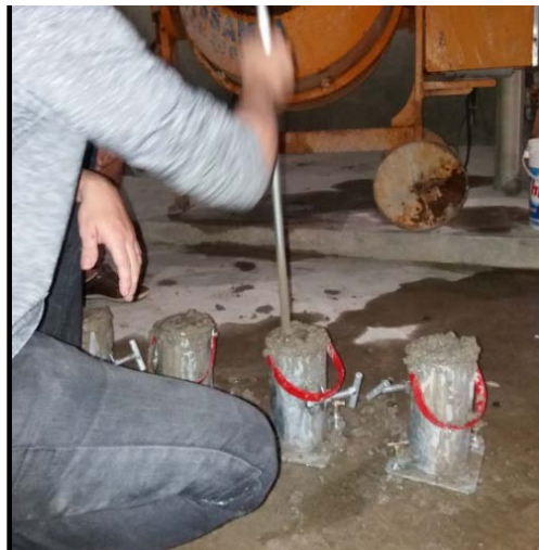
Figura 2. Adensamento manual do concreto.
