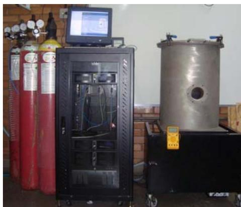
Figura 1. Equipamento de nitretação a plasma utilizado neste trabalho.
