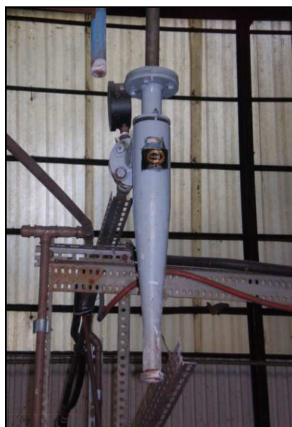
Figura 3: Ciclone utilizado nos ensaios de recuperação.
