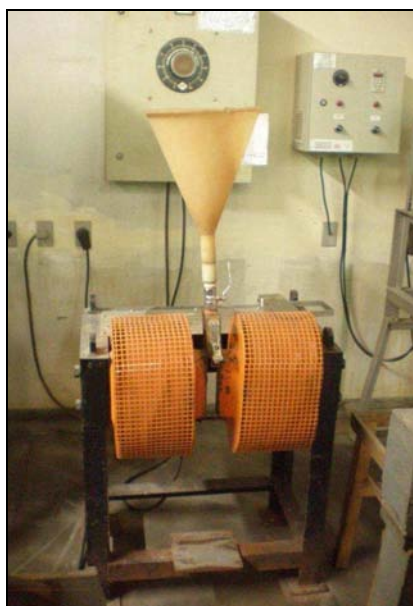
Figura 2: Separador magnético utilizado na primeira etapa do processo de separação magnética.
