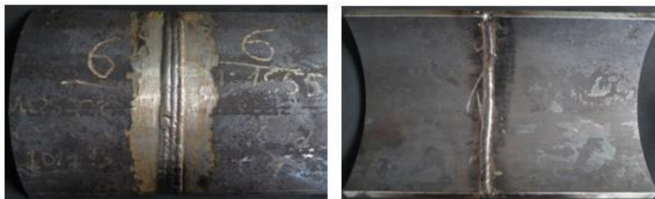
Figura Erro! Nenhum texto com o estilo especificado foi encontrado no documento.. Fotografia da junta soldada de um aço API 5L X65Q.
