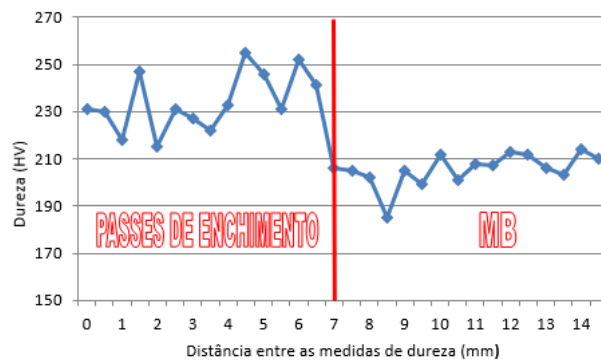
Figura 10. Perfil de microdureza na região central da soldagem abrangendo metal base, ZTA e ZF de um aço API 5L X65Q soldado.
