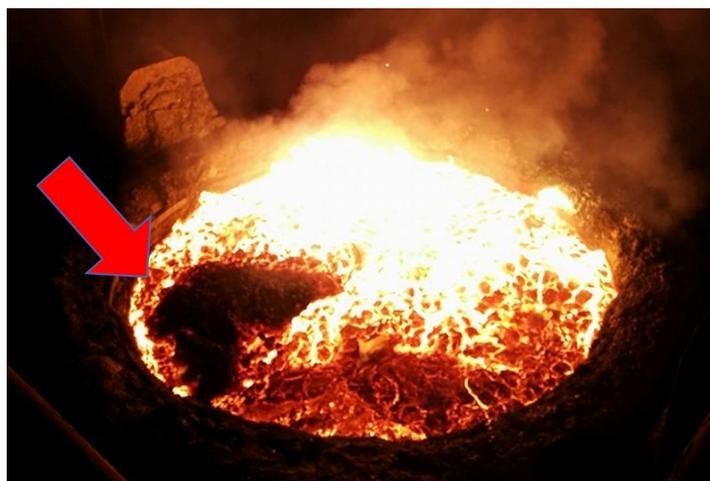
Figura 8 \_ Fração sólida na escória na chegada ao forno panela
