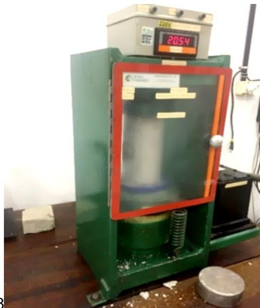
Figura 2. Prensa hidráulica utilizada no ensaio de compressão.
