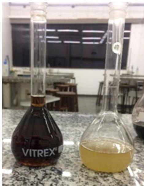
**Figura 7.** Resultados do ensaio de presença de orgânicos no agregado miúdo: à esquerda solução com ácido Tânico ( $C_{76}H_{52}O_{46}$ ) a 3% e à direita solução de NaOH a 3%.
