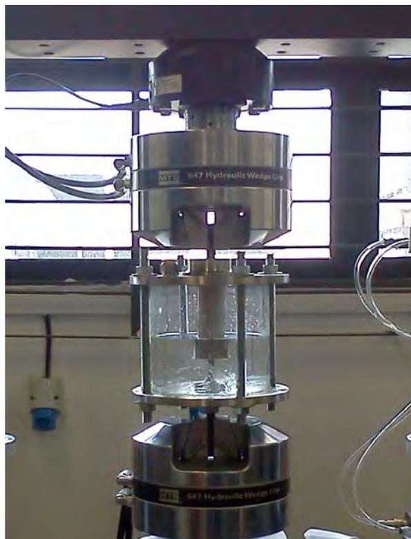
**Figura 2.** Câmera instalada em máquina de ensaio cíclico.
