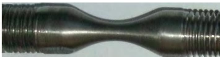
**Figura 1.** Corpo de prova de fadiga.
