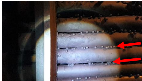
Figura 5 Exemplo de rolos agregados promovendo o fechamento dos gaps e aprisionamento/quebra de pelotas verdes.
