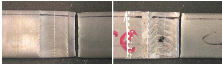
Figura 4 Posição de ruptura nas juntas da liga 6181 T4 soldadas com velocidades de 1 m/min (esquerda) e 10 m/min (direita).
