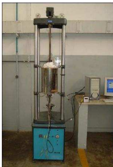
Figura.2. Forno de fluência utilizado nos ensaios.
