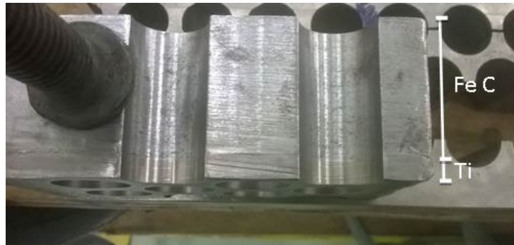
Figura 2. Espelhos de aço carbono ASTM A-515 revestidos com ERTi-1.
