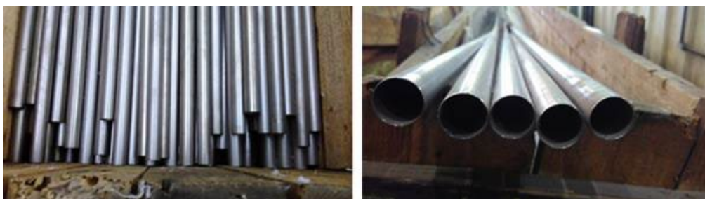
Figura 1. Tubos de titânio comercialmente puro (ERTi-1) grau 1.
