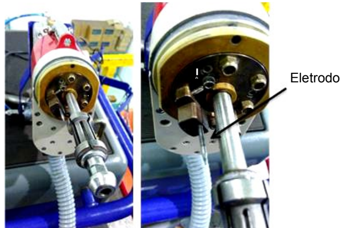
Figura 4. Eletrodo de tungstênio montado no cabeçote de soldagem.
