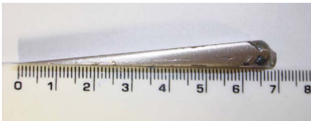
Figura 1: Amostra de liga ZrNiCu após coquilhamento.
