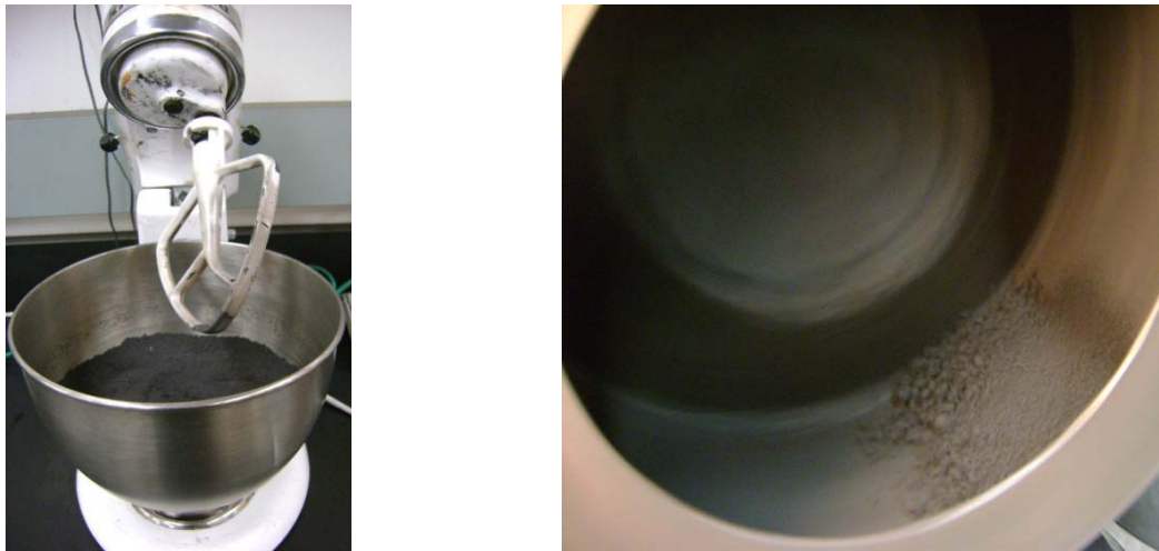
Figura 5 – Ensaios de pelotização: (5a) Misturador de laboratório (5b) tambor de aglomeração (balling drum)
