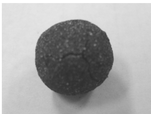
Figura 8 – Trincas em pelota confeccionada com bentonita após ensaio de resistência ao choque térmico (900°C).
