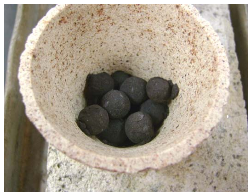
Figura 11 – Pelotas confeccionadas com carbonato de sódio após sofrer explosão durante o choque térmico.
