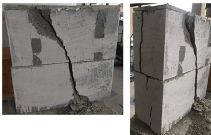
Figura 3. Modo de ruptura dos prismas com argamassamento parcial.
