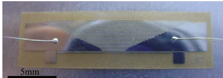
Figura 2-6: Extensômetro do tipo crack gage mostrando a rede de filamentos para medir a propagação de trincas de fadiga
