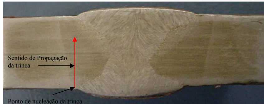
Figura 2-3: Macrografia da solda estudada
