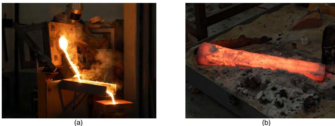
**Figura 1.** (a) Vazamento do metal líquido (b) Lingote desmoldado.
