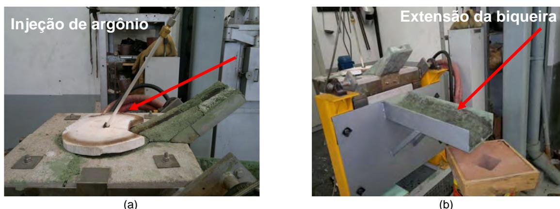
**Figura 2.** (a) Dispositivo para injeção de argônio. Como o argônio possui uma densidade maior que a da atmosfera, o fluxo imposto para dentro do metal líquido minimiza a entrada de oxigênio prejudicando esta etapa do processo. (b) Extensão da biqueira do forno.
