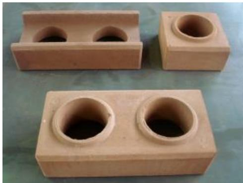
**Figura 1.** Tijolos modulares de solo-cimento.
