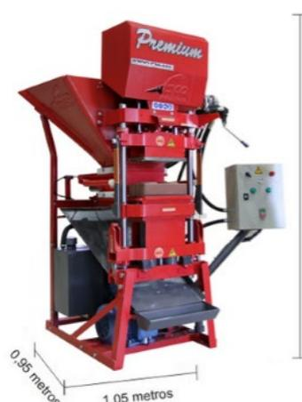
**Figura 1.** Prensa automática para produção dos blocos.
