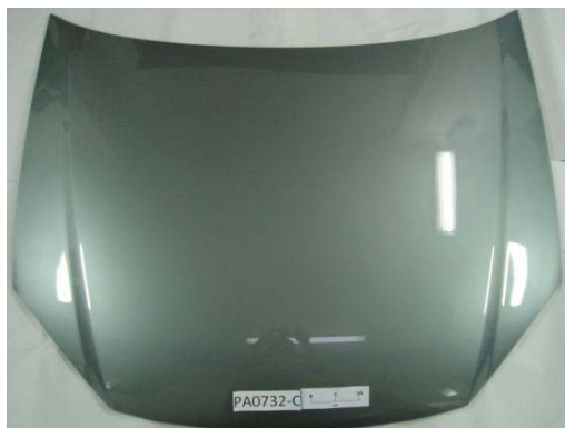
Figura 2. Capô de um automóvel estampado com o material normal de produção: aço FEP04.
