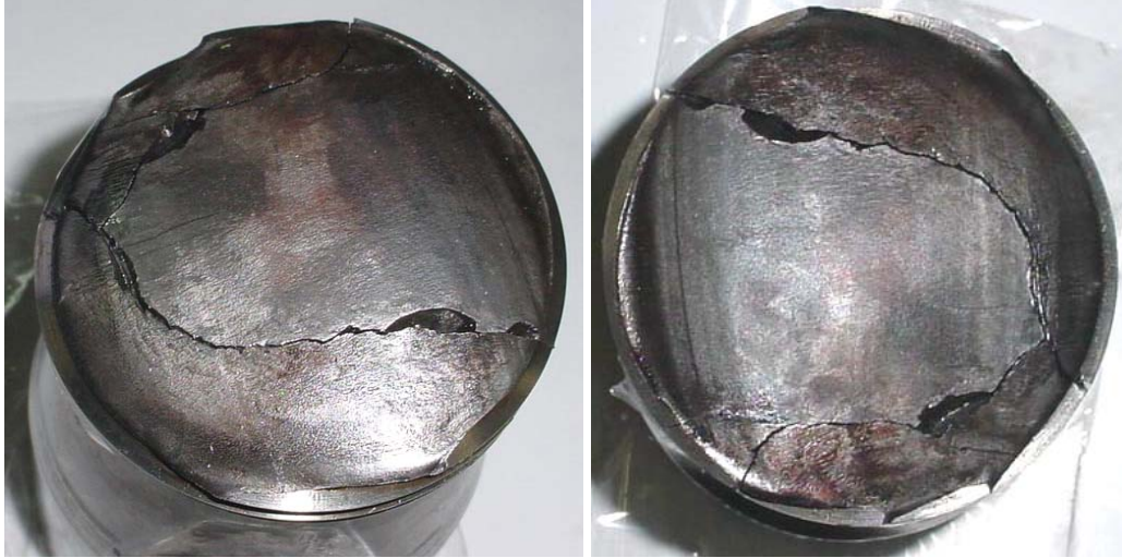
Figura 1 – Imagens mostrando uma das faces da fratura, onde ocorreram os lascamentos.
