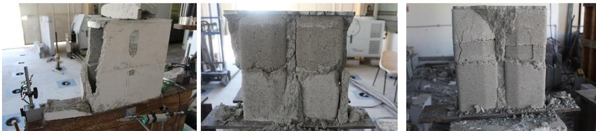
Figura 4- Módulo de ruptura prismas sem graute, graute convencional e leve, respectivamente
