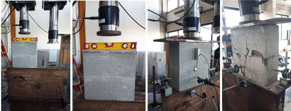
Figura 4- Ensaio de resistência a compressão
