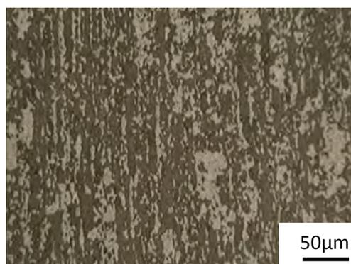
**Figura 4.** Fotomicrografia aço austeno-ferrítico laminado ( $\epsilon = 0,50$ ) – microscopia óptica, reativo Behara II.
