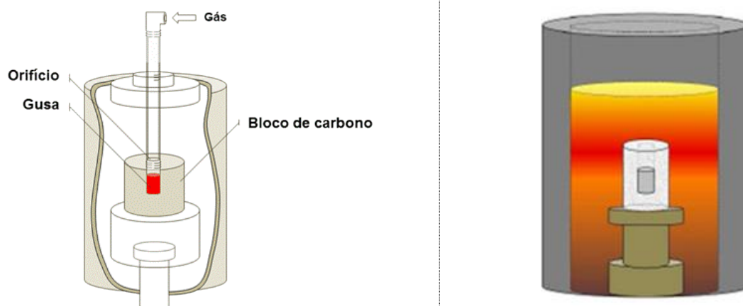
Figura 2. Representação esquemática do ensaio de penetração de gusa.
