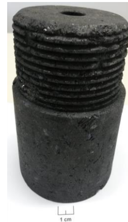
Figura 3. Representação esquemática e foto ilustrativa do corpo de prova de bloco de carbono para o teste de penetração.
