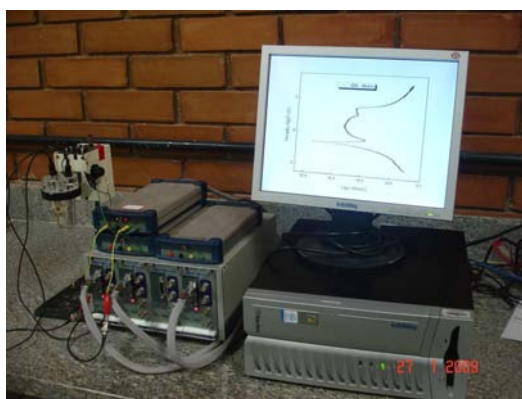
Figura 3. Aparelho de corrosão Omnimetra Instrumentos, Mod. PG39A, em operação.
