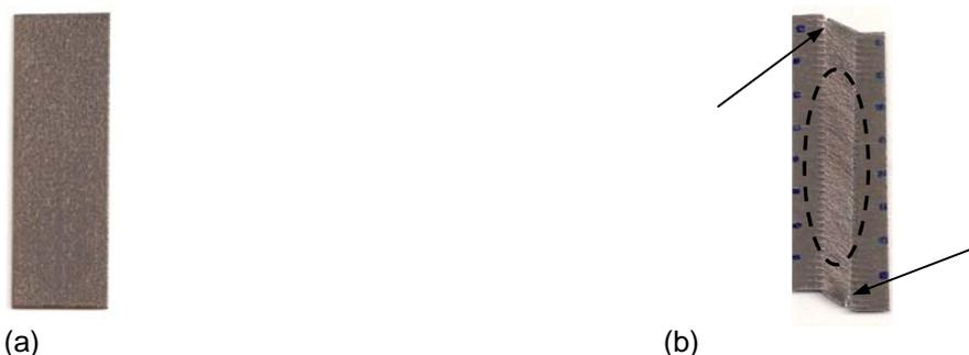
**Figura 5.** Corpos de prova de cisalhamento utilizados para a deformação plástica em carregamento monotônico do aço GNO: (a) antes do ensaio e (b) após o ensaio.
