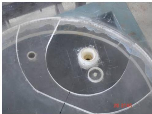
**Figura 7** – Fundo Falso para Reduzir Volume Residual.
