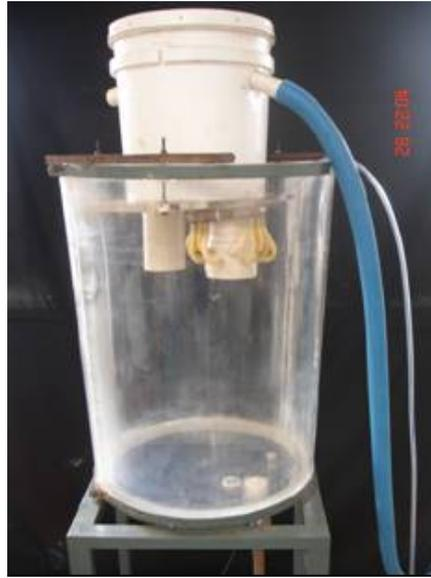
**Figura 3** – Vista Geral do Modelo com Réplica do Reator RH.
