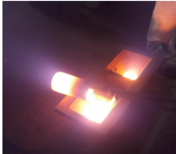
Figura 04: Vazamento do ferro gusa líquido no molde.
