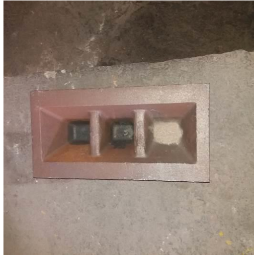
Figura 03: Carbureto de cálcio depositado no fundo do molde para receber o ferro gusa líquido. Após foi vazado no molde o ferro gusa líquido, por cima do carbureto de cálcio adicionado, como mostra da Figura 04.
