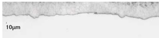
Figura 13. ABNT 304 – 3,0mm– Decapagem com HCl + H 2 O 2 . seção transversal, microscopia ótica
