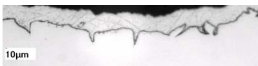
Figura12: ABNT 304 – 3,0mm – Decapagem com HF-HNO 3 , seção transversal, microscopia ótica
