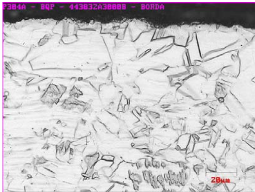
Figura 16. UM 443832A03 bobinada abaixo de 580°C – não sensibilizada . Ataque oxálico. 500X
