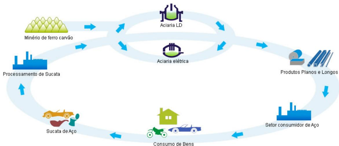
Figura 2. Fluxograma do processo de reciclagem do aço.<sup>(5)</sup>
