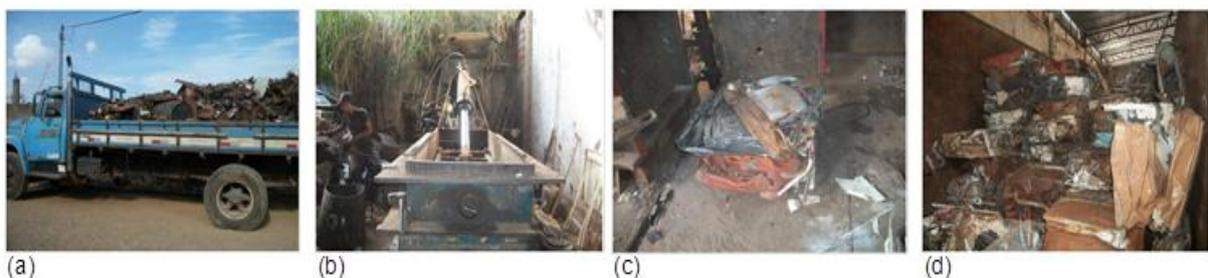
**Figura 6.** Algumas etapas do processo de preparação da sucata nos sucateiros. (a) recepção da sucata; (b) prensa; (c) sucata prensada; (d) contêiner sendo carregado para envio às indústrias.
