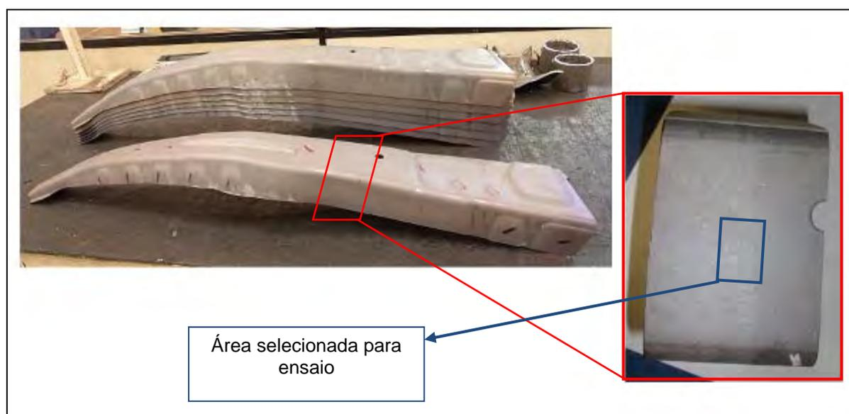
Figura 3. Área da amostra selecionada para ensaio metalográfico.
