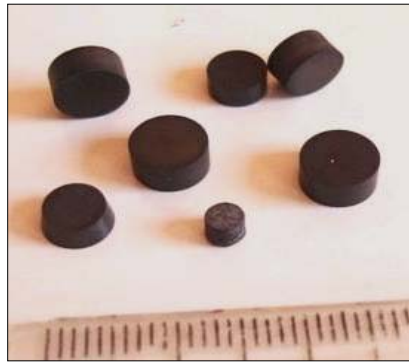
Figura 2. Geometria das amostras depois de retificadas.
