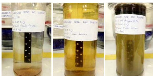
Figura 4. Fotos dos cupons de corrosão/deposição imersos em condensado de GCO.
