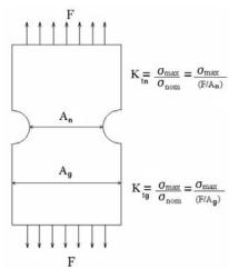
Figura 1. Representação esquemática das duas definições de K<sub>t</sub>.
