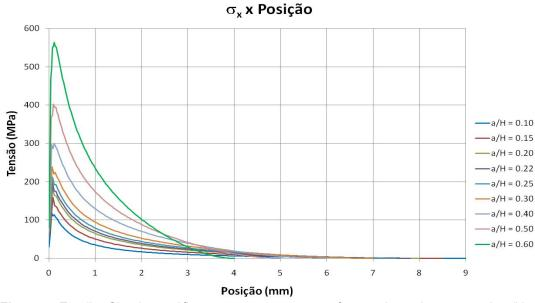
**Figura 7.** Entalhe Simples: gráficos para a tensão  $\sigma_x$  em função da posição em cada a/H.
