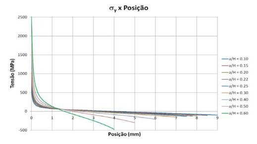
**Figura 10.** Entalhe Simples: gráficos para a tensão  $\sigma_v$  em função da posição em cada a/H.
