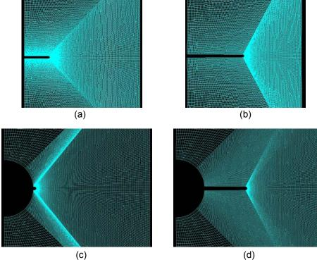
**Figura 5.** Malha do modelo estudado para o entalhe simples com profundidade de (a) 0.22 e (b) 0.50; e para o entalhe composto com profundidade de (c) 0.22 e (d) 0.50.
