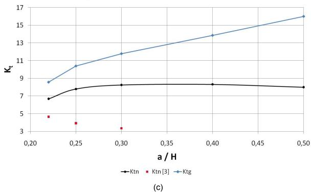
**Figura 6.** Gráfico com as curvas de  $K_{tn}$  (a) e  $K_{tg}$  (b) para o entalhe simples e o composto, para o caso de flexão. Gráfico com as curvas de  $K_{t}$  para o caso do entalhe composto em tração pura (c). Os quadrados vermelhos representam valores obtidos na literatura. (3)
