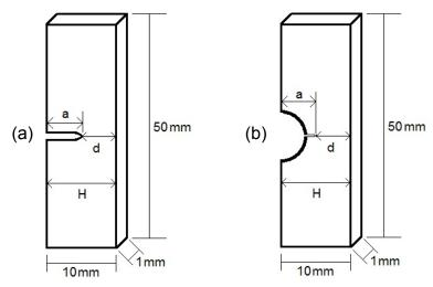
**Figura 3.** Formato e dimensões do corpo de prova simulado no MEF: (a) entalhe simples; (b) entalhe composto.
