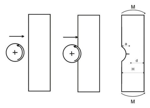
**Figura 2.** O entalhe composto é gerado pela ação de uma ferramenta de corte (ou desbaste) e posterior acabamento.
