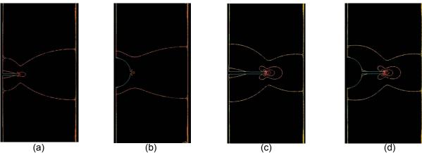
**Figura 9.** Campos de tensões  $\sigma_x$  para entalhe simples com profundidade de (a) 0.22 e (c) 0.50; e para entalhe composto com profundidade de (b) 0.22 e (d) 0.50.
