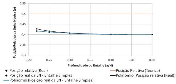
**Figura 13.** Gráfico com as posições relativas da linha neutra em função da profundidade do entalhe para os casos de flexão. A linha em vermelho escuro representa o comportamento de uma viga sem entalhe.
