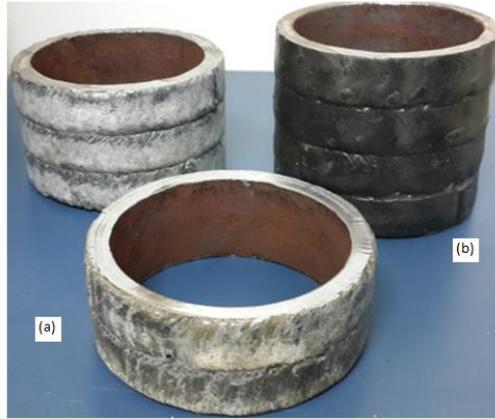
**Figura 2.** Cordões obtidos após revestimento com: (a) Liga A; e (b) Liga B.
