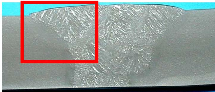
Figura 1: Macrografia da junta obtida.
