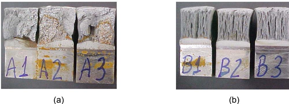
**Figura 3:** (a) Corpos-de-prova com entalhes na ZAC; (b) Corpos-de-prova MB, após ensaio de CTOD e rasgamento para medição da pré-trinca.
