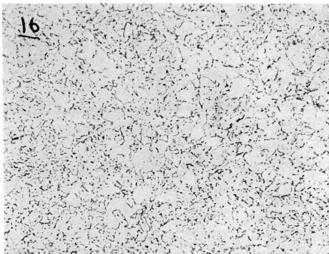
Fig. 16 — Micrografia da chapa D-7, temperada e recozida a 690°C durante 2 horas. Cementita globular fina sobre fundo ferrítico de grão n.º 8 ASTM (76,8 Rb). 500 ×; ataque nital.
