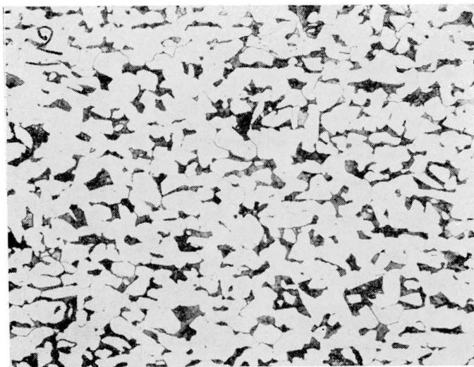
Fig. 2 — Micrografia da chapa B, laminada em condições normais e resfriada ao ar do bobinamento. Estrutura homogênea. Grão ferrítico nº 8 ASTM. 250 x; ataque nital.
