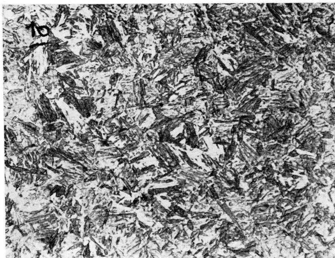
Fig. 10 — Micrografia da chapa D-1, temperada em água salgada a 0°C. Martensita grossa (47,9 Rc).
