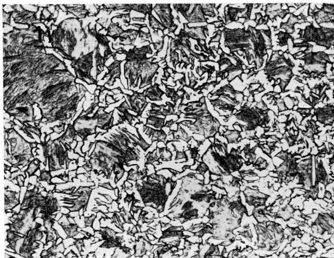
Fig. 11 — Micrografia da chapa D-2, temperada em água a 25°C. Ferrita envolvendo grãos de bainita e martensita abundantes (39,2 Rc). 500 ×; ataque nital.
