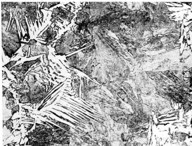
Fig. 14 — Micrografia da chapa D-5, temperada em óleo. Ferrita acicular e perlita fina (93,7 Rb). 500 ×; ataque nital.
