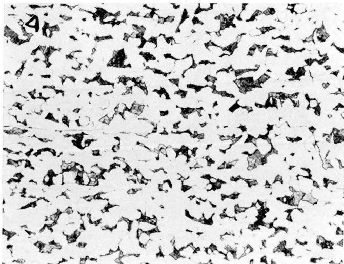
Fig. 4 — Micrografia da chapa D, laminada em condições normais e resfriada com água (jato brando) antes do bobinamento. Estrutura homogênea. Grão ferrítico n.º 8 ASTM. 250 ×; ataque nital.
