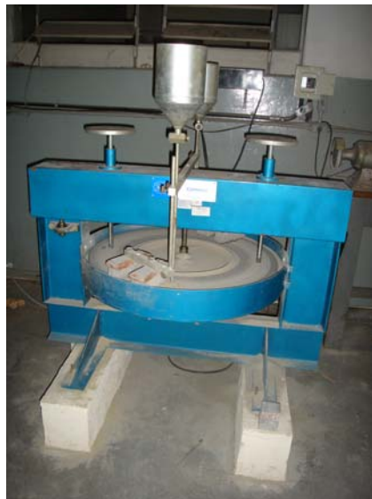
Figura 2: Máquina de ensaio de abrasão.
