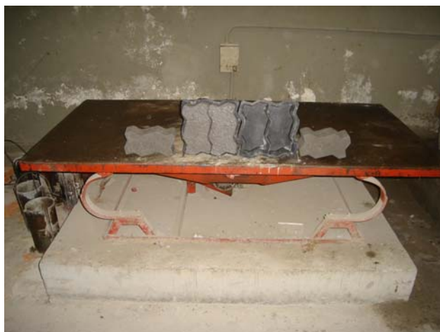
Figura 1: Mesa vibratória, moldes e componentes fabricados.
