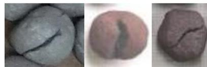
**Figura 3.** Pelotas com trincas mecânicas.
