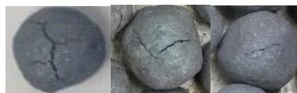
**Figura 4.** Pelotas com trincas térmicas.
